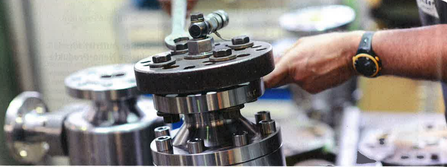
Montagearbeit an einer Pumpe: Das Produkt besteht fast komplett aus dem Werkstoff Stahl.
